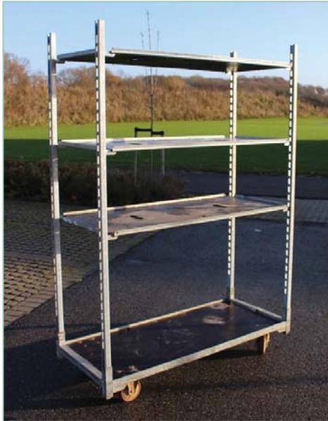
FIGUR 8. TRADITIONEL RULLECONTAINER (CC CONTAINER) MED HÅRDE HJUL OG LØSE PLADER UDEN SÆRLIG STØJDÆMPNING.
