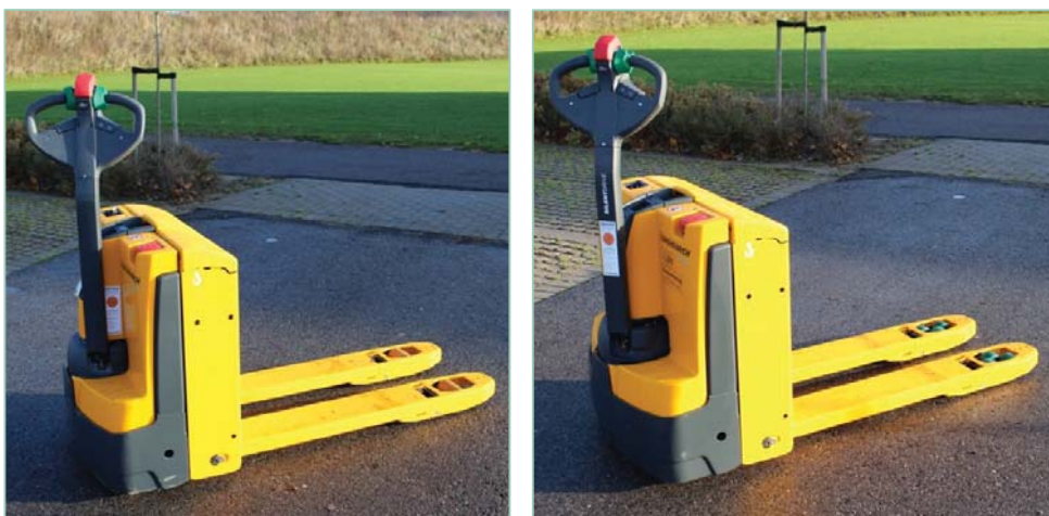
FIGUR 5. EL-PALLELØFTER. TIL VENSTRE I EN STANDARDUDGAVE UDEN SÆRLIG STØJDÆMPNING. TIL HØJRE I EN VERSION MED ET PÅBYGGET STØJDÆMPNINGSKIT (BEMÆRK BL.A. DE ÆNDREDE HJUL PÅ GAFLERNE). DEN STØJDÆMPEDE VERSION ER PIEK-CERTIFICERET.
