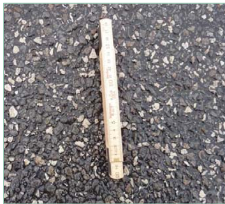
FIGUR 13. UNDERLAG ANVENDT VED MÅLINGER PÅ JÆVN ASFALT. TIL VENSTRE: FORHOLDSVIS FINKORNET BELÆGNING. TIL HØJRE: FORHOLDSVIS GROVKORNET BELÆGNING.
