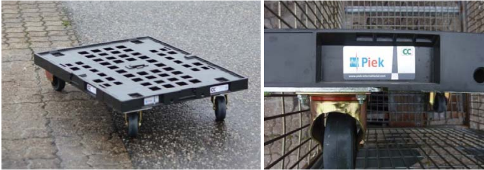
FIGUR 12. STØJSVAG, PIEK-CERTIFICERET HALVPALLE (CC EURO ROLLEY).
