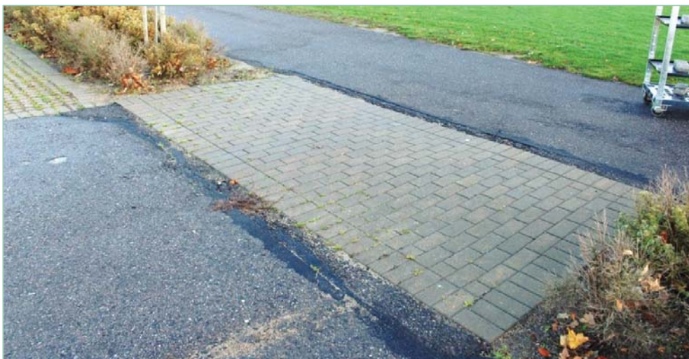
FIGUR 15. UNDERLAG ANVENDT VED MÅLING AF STØJ FRA PASSAGE AF OVERGANGE MELLEM FORSKELLIGE BELÆGNINGSTYPER. DER KAN VÆRE STOR FORSKEL PÅ STØJEN FRA FORSKELLIGE TYPER OVERGANGE MELLEM BELÆGNINGER.
