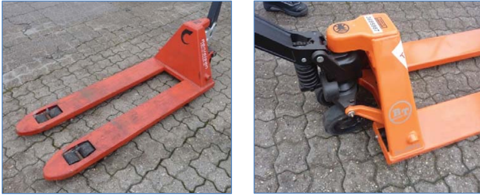
FIGUR 6. MANUELLE PALLELØFTERE. EN TRADITIONEL TIL VENSTRE OG EN STØJSVAG PIEK-CERTIFICERET MODEL TIL HØJRE MED BLØDE HJUL.
