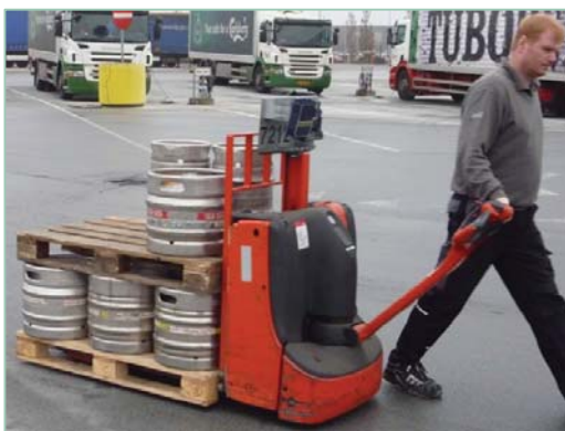
FIGUR 4. TYPISK EL-PALLELØFTER UDEN SÆRLIG STØJDÆMPNING
