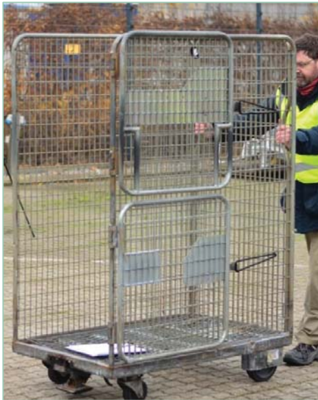
FIGUR 7. TRADITIONELT SÅKALDT POSTBUR UDEN SÆRLIG STØJDÆMPNING.
