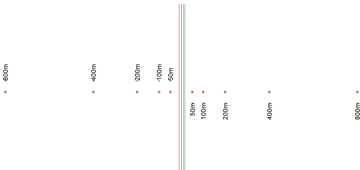
Figur 4 Soundplan model af nord-sydgående vej inkl. beregningspunkter samt støjskærm på østlig side af vejen. (Vejens udstrækning går udenfor figuren)
