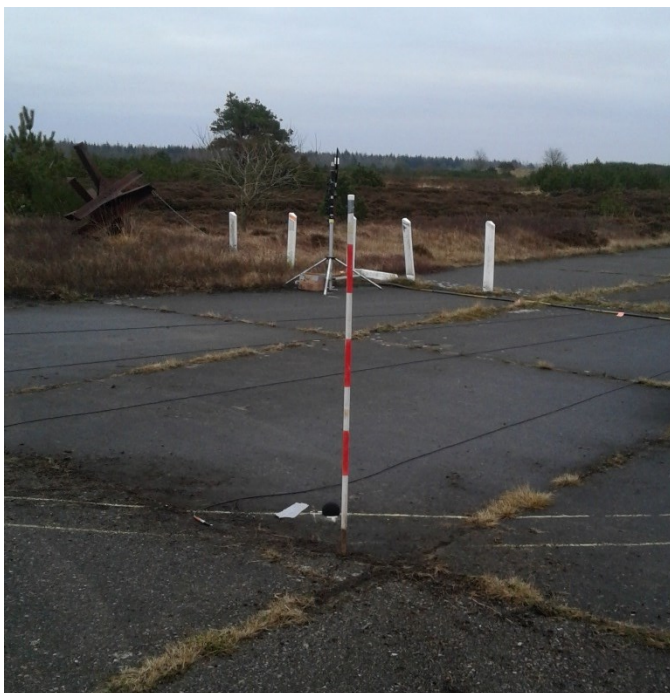
Figur 2. Opstilling for måling af udgangsværdier. Skudretningen 0° er markeret med en pind.
